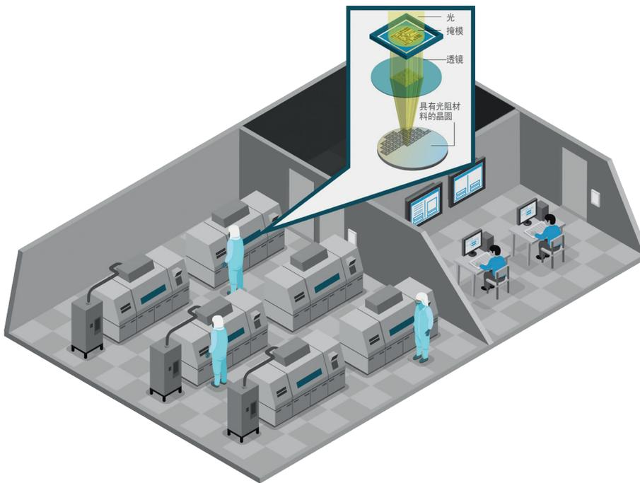
晶圆制造需要受到严格把控的环境和精确的制造环境数据。这些基本要素可实现在晶圆表面上快速呈现高精度的刻画电路图形。
