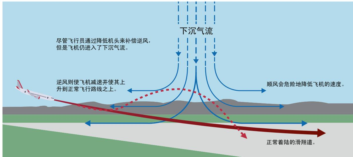
图 1: 下击暴流对飞行路线的影响
